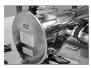
• 设备在受压的情况下绝不能拆除插座盖。使用插座盖的目的是为了在压紧螺母出现严重故障时能保护操作员不受从设备进出的任何玻璃、水或其它材料的伤害。尤其是在设备操作未遵守所有适用维护规程的情况下,包括未及时更换损耗组件(如灯具和CPVC压紧螺母)在设备受压时拆除终端盖会使灯、套管,或其中的部件有力进出,从而可能带来操作员或他人严重的身体伤害或死亡。在拆除插座盖之前应关闭输入和输出阀,并小心慢慢地打开排水管、放气管或同类阀门对设备进行绝缘和减压,从而以消除风险。
